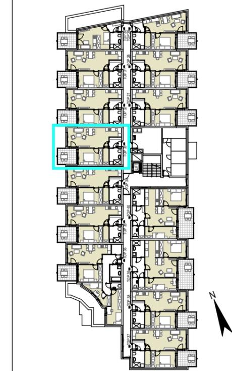
Alle offenbaren Fenster sind Drehkippenster, restliche Fenster sind fixverglast. Dargestellte Einrichtungsgegenstände sind unverbindliche Vorschläge, zulässige Bautoleranzen sind möglich, Planmaße sind Rohbaumaße.
